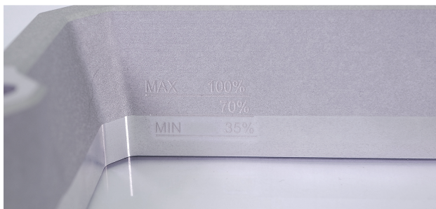
Ryska maximálního množství resinu v tiskové vaničce.
