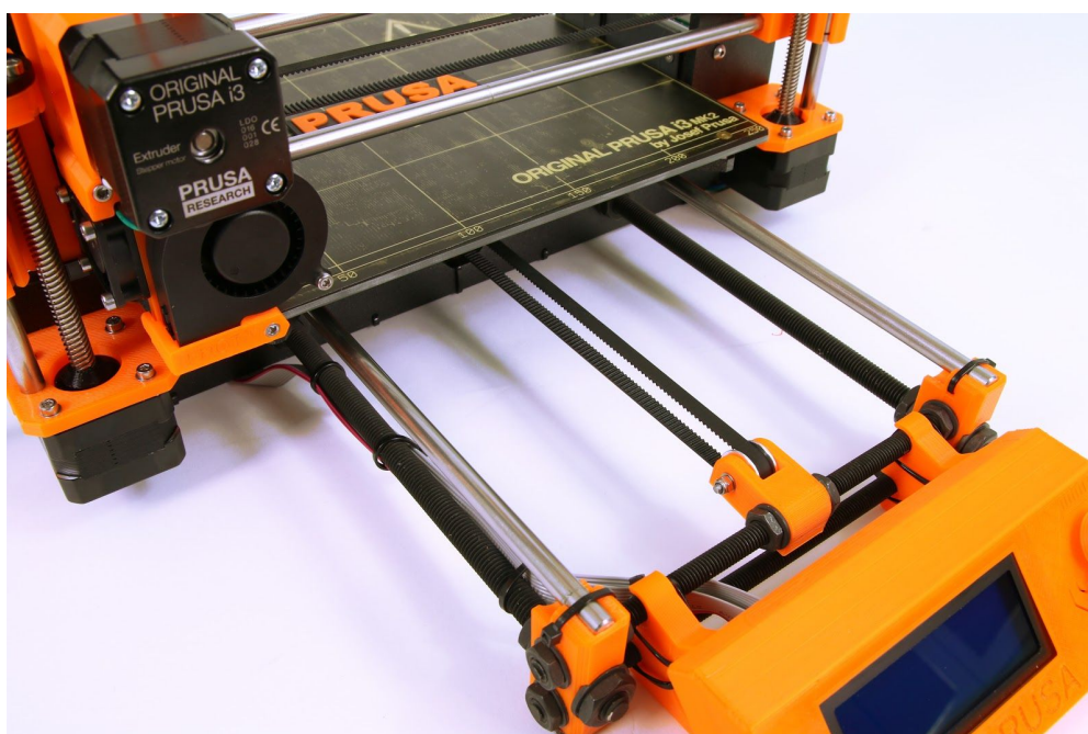
Obr. 38 - Správně napnutý řemen pod vyhřívanou podložkou
