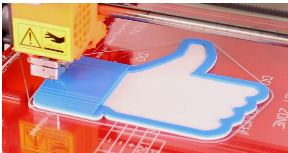
Obr. 28 - Vícebarevný objekt tisknutý pomocí Colorprintu
