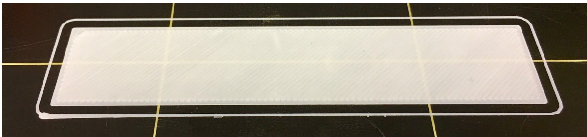
Obr.10 - Perfektní první vrstva Průša loga
